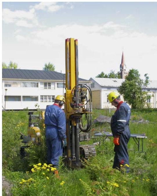
Kuva 1. GTK:n tela-alustainen kairauskone Raahen Kauppakadulla (kuva: T. Kallio-Seppä, Museovirasto).
