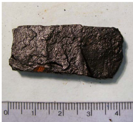
Kuva 2: Yksi Mankbyn rautaharkoista (KM 2009032: 513), joka katkaistu toisesta päästä. Harkon pituus 36 mm, leveys 17 mm ja paksuus 5 mm, paino noin 22 g. Kuva: Elina Terävä, Helsingin Yliopisto.
