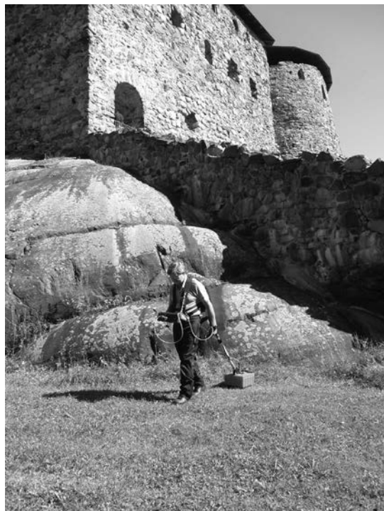
Maatutkakartoitusta (Geoworks Oy) Raaseporin linnan edustalla elokuussa 2009. Kuva Georg Haggrén..
