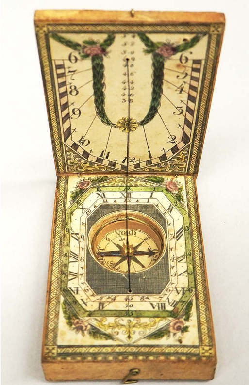
Kuva 8. PPM-kellon pystysuoralla tasolla on vertikaaliaurinkokello ja alakannessa horisontaaliaurinkokello sekä kompassi. Kuva: Susanna Kuokkanen.
