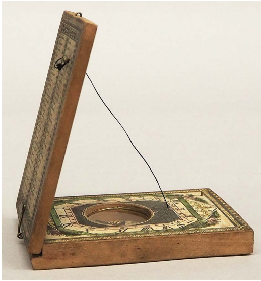
Kuva 6. PPM-kello ei aukea normaaliin 90 asteen kulmaan. Kuva: Susanna Kuokkanen.
