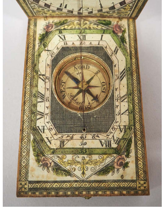
Kuva 3. PPM-kellon horisontaalasteikko. Asteikossa on kolme eri kehää. Uloimman leveysaste on 50, keskimmäisen 45 ja sisimmän 45. Huomaa maantieteellisen pohjoisen merkintä pohjoisesta länteen. Tässä osoitin osoittaa kaakkoon. Kuva: Susanna Kuokkanen.
